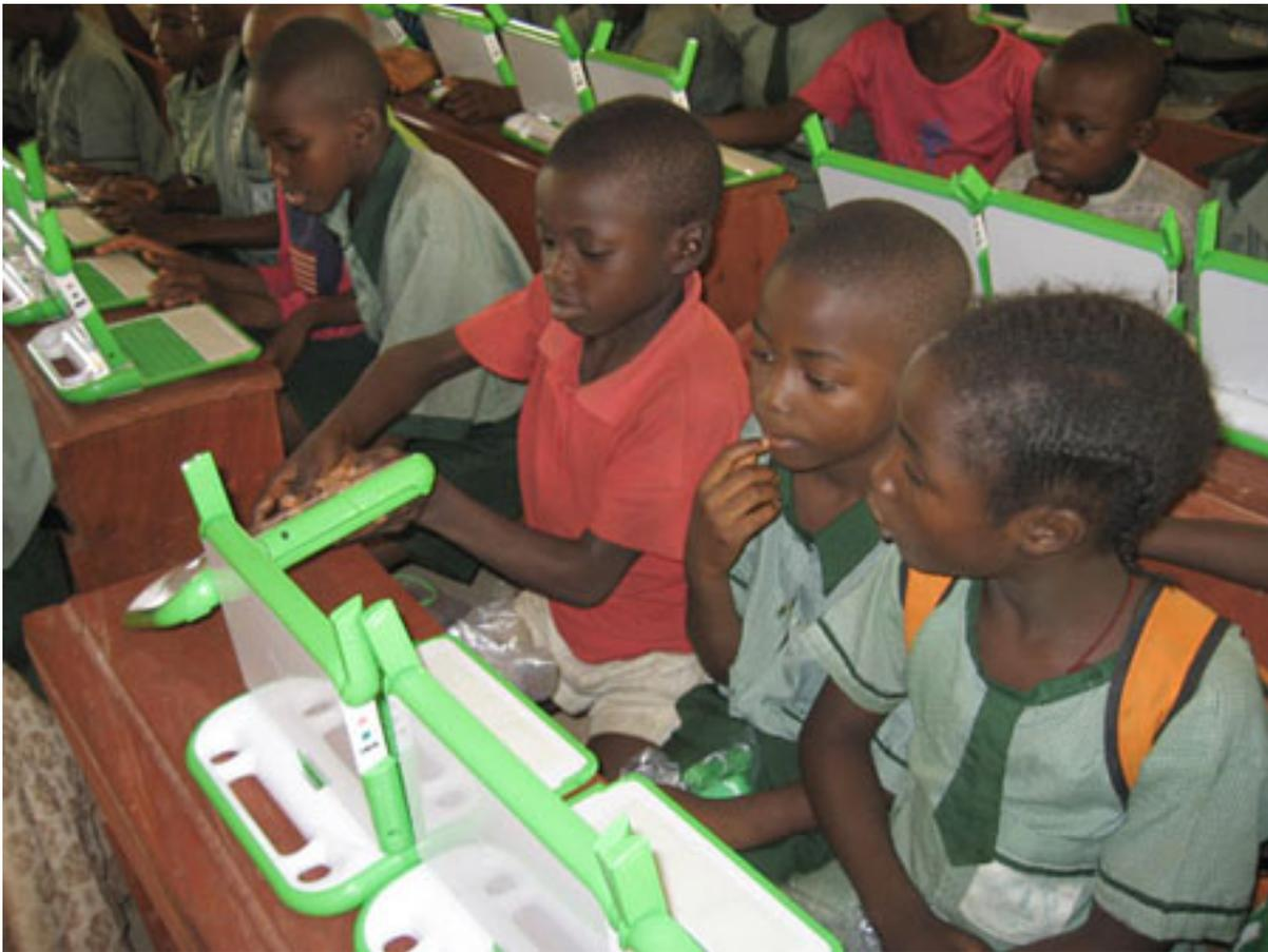
El XO, como se conoce el ordenador diseñado por Negroponte, no necesita estar conectado a la red eléctrica. La energía se genera girando dos manivelas situadas al lado de la pantalla. Cuesta 125 euros y utiliza un sistema operativo abierto, además de disponer de cámara y conexión a redes inalámbricas. El procesador es de AMD.
